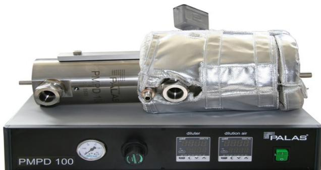
Система разбавления, предназначенная для удаления летучих частиц и разведения высококонцентрированных аэрозолей. Система разбавления PMPD используется для измерения выхлопов транспортных средств и реактивных двигателей.
