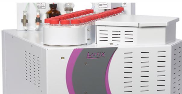
Анализатор Lotix предназначен для точного измерения содержания органического углерода в водных матрицах с концентрацией от нескольких микрограмм на литр. Он использует проверенную технологию сгорания при высокой температуре, окисление углеродного материала в углекислый газ, и обнаружение с помощью нового недисперсионного инфракрасного детектора.
