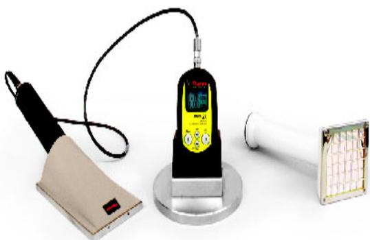
Радиометры RadEye GX и SX - это передовые компактные многоцелевые поисковые приборы с внешними подключаемыми счетчиками Гейгера-Мюллера (RadEye GX) или сцинтилляционными детекторами (RadEye SX). С их помощью могут быть измерены: скорость счета частиц и мощность дозы различных видов излучения.
