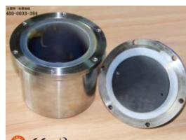
Вакуумный размольный стакан, футерованный агатом
