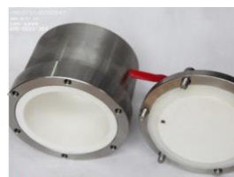
Вакуумный размольный стакан, футерованный оксидом циркония
