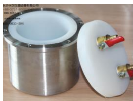
Вакуумный размольный стакан, футерованный нейлоном
