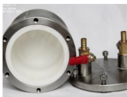
Вакуумный размольный стакан, футерованный оксидом алюминия
