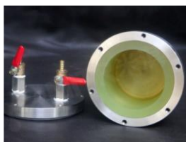
Вакуумный размольный стакан, футерованный полиуретаном
