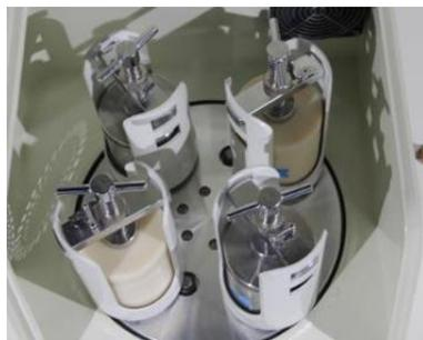
**Запатентованная технология U-образного защитного кожуха** размольного стакана обеспечивают высокую степень надежности и безопасности
