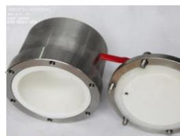
Вакуумный размольный стакан, футерованный оксидом циркония
