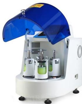
**Широко открывающаяся защитная крышка с системой фиксации** в открытом положении для удобного извлечения и загрузки стаканов
