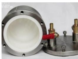
Вакуумный размольный стакан, футерованный оксидом алюминия
